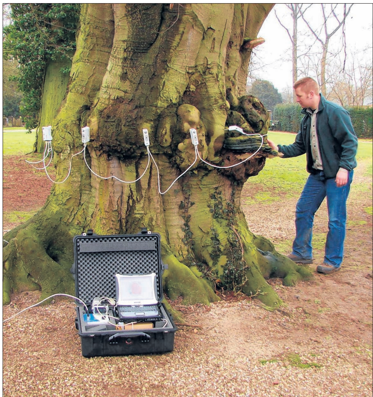
Ronald Wobben aan het werk met apparatuur waarmee hij met geluidsgolven kan 'zien' waar een boomstam rot is. Eigen foto
